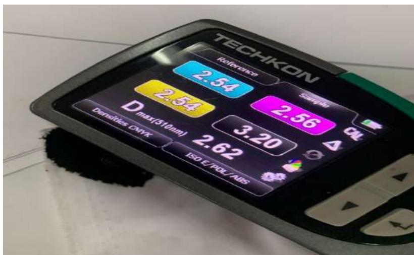
Gambar 5. Pengujian Kepekatan Warna
